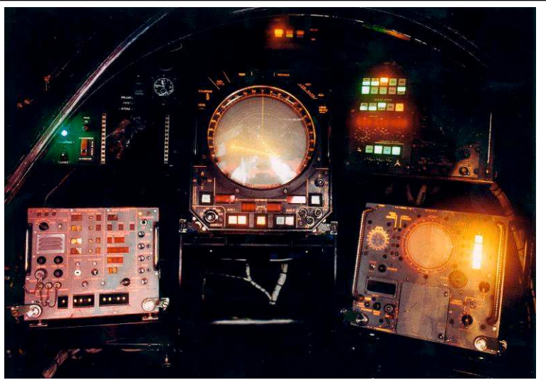
LE POSTE DU RADARISTE : LE RADAR AU CENTRE ENCADRE DU DETECTEUR DE RADAR. A GAUCHE
