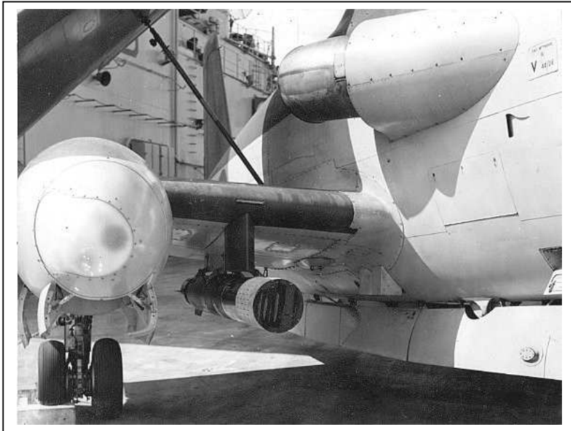
Torpille MK 44 sous l'aile de l'Alizé sur le pont du porte-avions
