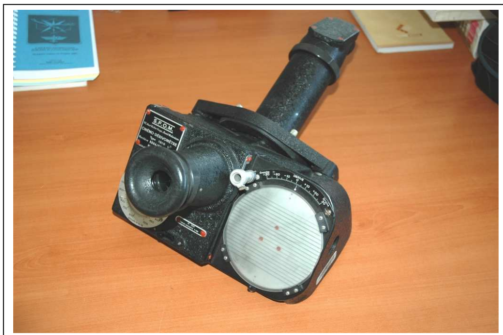
CINEMODERIVOMETRE SFOM qui permettait de mesurer les dérives et vitesses sol nécessaire au calcul du vent.
